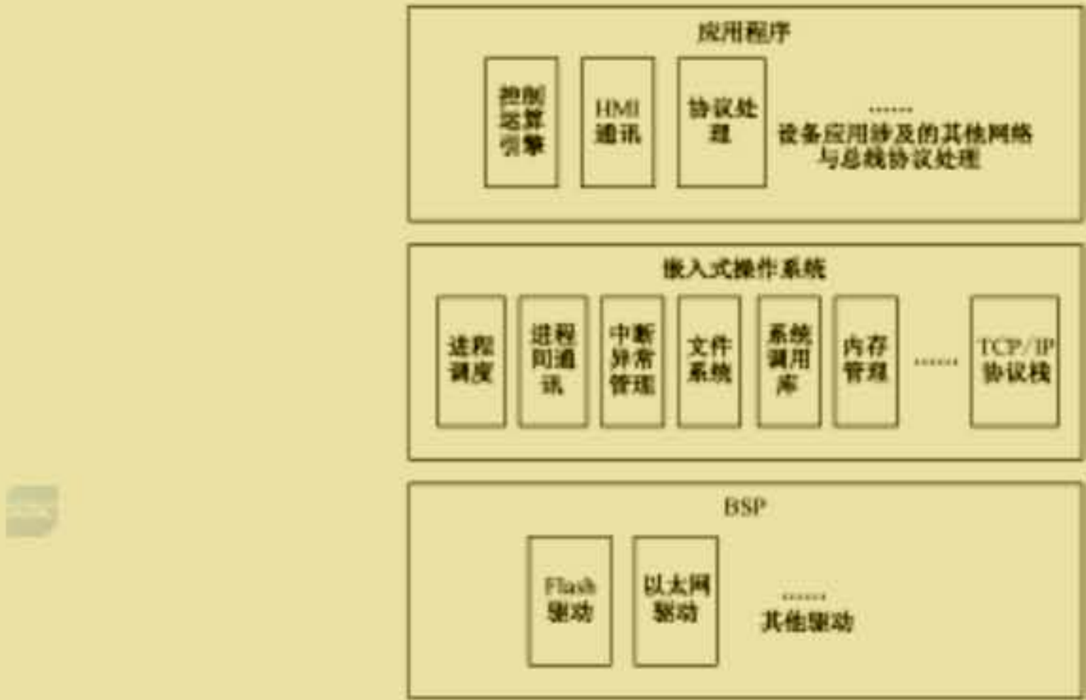
图 A.2 嵌入式工业控制系统现场测控设备典型软件架构
